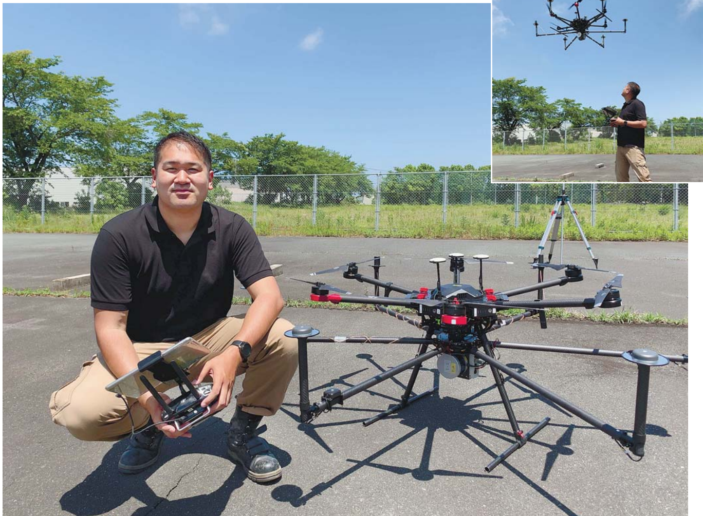
測量に使うドローンと松本紘明さん。ドローンはレーザーを載せて50~60mの高さまで揚げられます=どれもテラドローン提供
